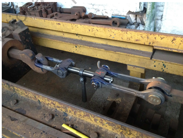
Système d'attache sur un banc d'essai de traction
